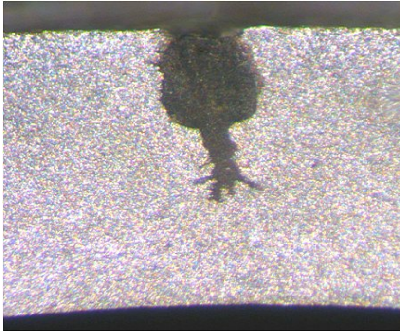
Рис.2 Питтинг на поверхности теплообменных трубок
